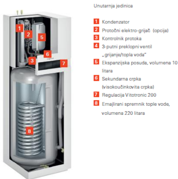
Slika 3. Presjek unutarnje jedinice dizalice topline, zrak – voda, tip Vitocal 111-S
